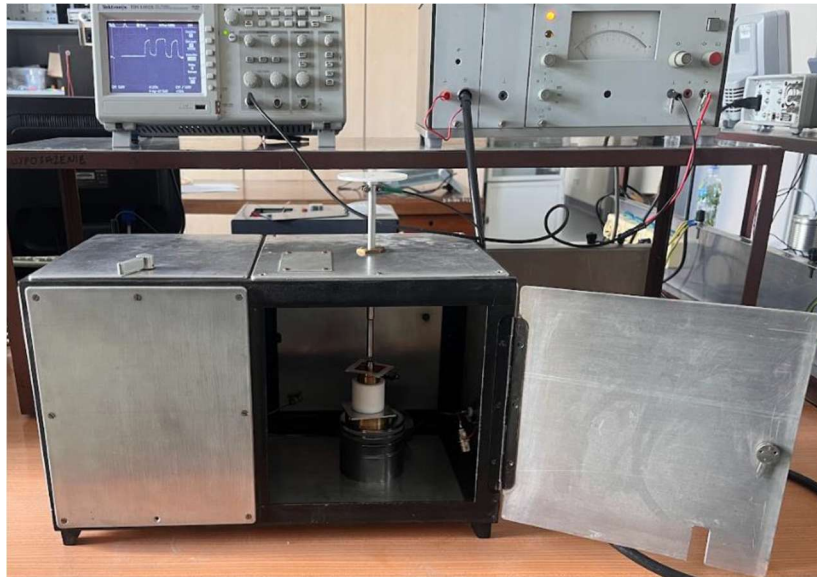
Rys. 27. Stanowisko do pomiaru współczynnika d_{33} metodą statyczną z wykorzystaniem elektrometru
