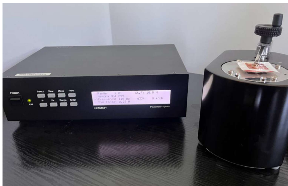
Rys. 25. Stanowisko do oznaczania współczynnika d_{33} metodą Berlincourta
